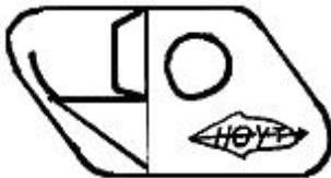
Le repose flèche le plus simple est en matière plastique et s'appelle le Hoyt Super Rest. Ce repose flèche doit être placé suffisamment haut du plancher de l'arc pour laisser passer les plumes de la flèche. C'est-à-dire au moins 15 mm. Le Super Rest est fixé avec un adhésif. Certains compétiteurs n'utilisent que lui. On le change de temps en temps, lorsqu'il donne des signes de fatigue! On coupe juste l'ergot qui pourrait frotter sur la plume coq et c'est tout!
